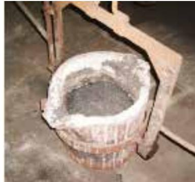
Figura 7 – Panela de vazamento manual
