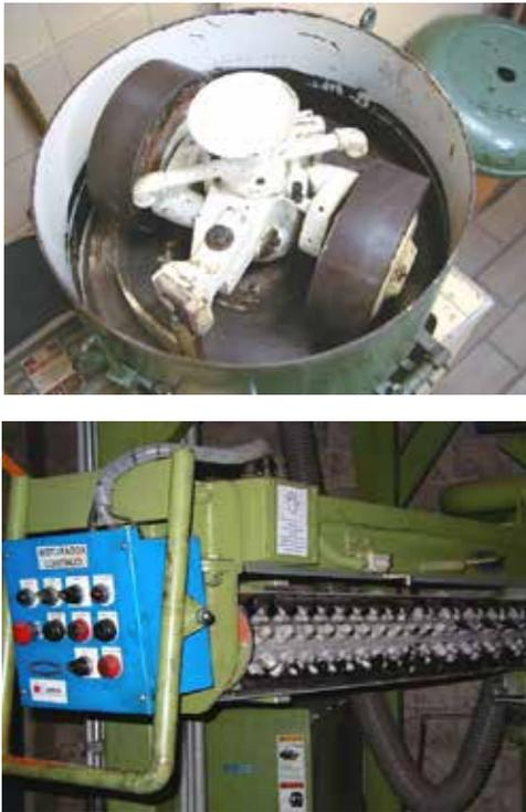
Figura 16 – Misturadores empregados na preparação de areia de fundição
