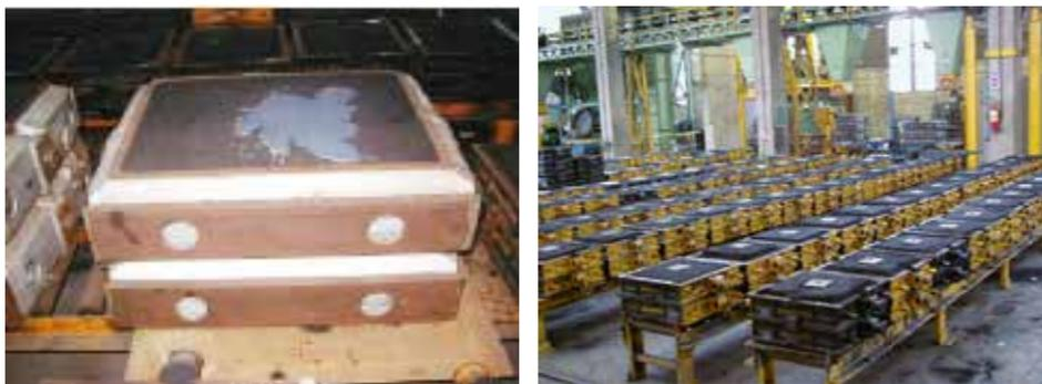
Figura 3 - Moldes de peças confeccionados com areia aglomerada com argila
