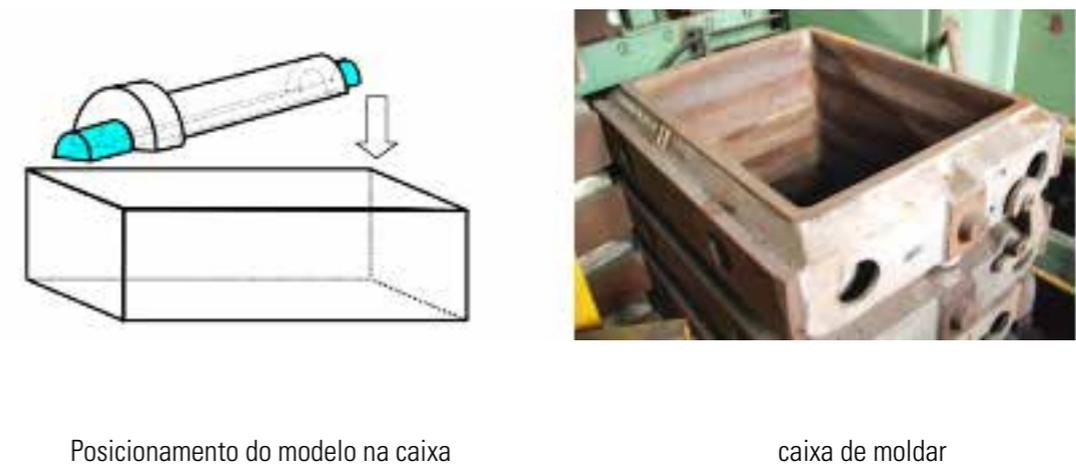
Figura 9 - Posicionamento do modelo no interior da caixa de moldar
