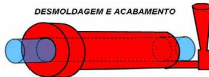
Figura 15 – peça fundida depois de retirada do molde
